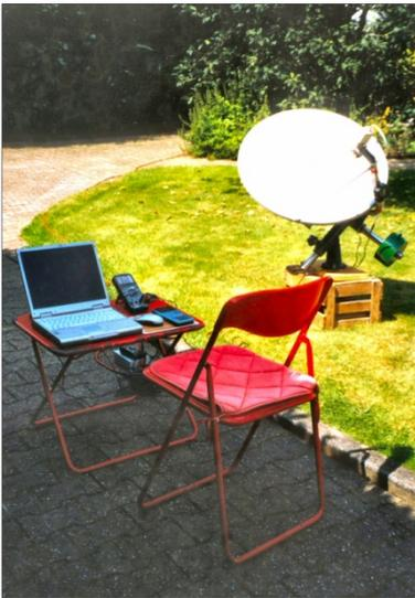
Abbildung 1 Messaufbau 2004 (10 GHz): Parabolantenne, Stromversorgung (unter dem Klapptisch), Datenlogger und PC
