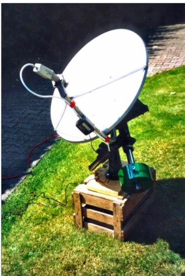
Abbildung 2 Messaufbau 2004 (10 GHz), Details: Parabolantenne mit LNC und Satfinder. Parallaxische Montierung
