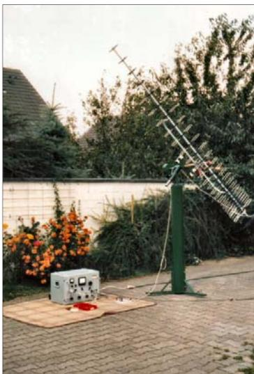
Abbildung 4 Messapparatur 1991 (625 MHz): 23-Element-Yagi-Antenne (parallaktisch montiert) und Pegelmessgerät (Gebrauchtgerät Type USVD BN 1523, Rohde & Schwarz, München)
